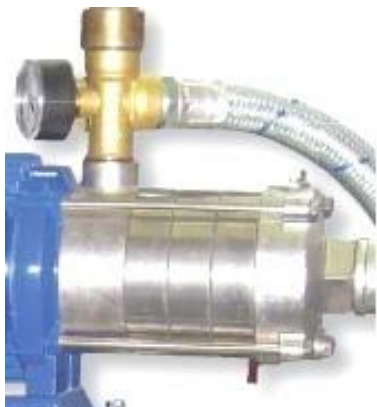
Obrázek 6: Výstup vícestupňového čerpadla s manometrem, kam bude osazen snímač tlaku
