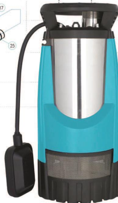
Řada vysokotlakých ponořitelných čerpadel určených k zalévání. Čerpadla mají kryt z nerezové oceli a vícestupňový hydraulický systém. Jsou vybavena chladicím pláštěm, díky němuž nemusí být zcela ponořena. Podstavec čerpadla je zakončen filtračním sítím, které umožňuje čerpat vodu do hladiny 10 cm. Obě čerpadla Multi IP INOX jsou vybavena plovákovým spínačem, díky čemuž je jejich práce ovládána automaticky. Všechna čerpadla jsou vybavena tepelnou ochranou namontovanou do vinutí motoru.
